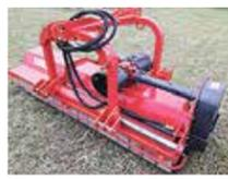
**Schlegelmulcher** Aktion von 160 bis 220 cm Arbeitsbreite, z.B. 200 cm mit Front- und Hecktrieb, hydraulischer Verschluss, 4-fach Keilriemen, 1.300 Gramm Schlegel, Gelenkwelle, € 3.990,- inklusive Mehrwertsteuer, Tel. 0699/88491441, [aigner-landtechnik.at](http://aigner-landtechnik.at)
