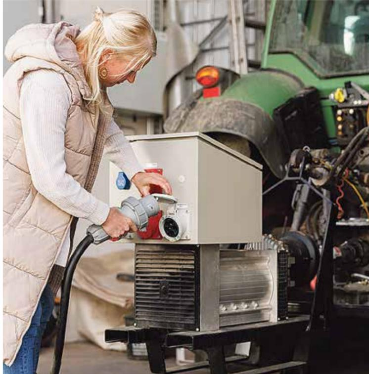
Bleibt der Strom länger weg, ist es wichtig, zumindest einen Notstrom-Einspeisepunkt am Hof zu haben. Über diesen können verschiedene Systeme von Notstromaggregaten sicher die wichtigsten Anlagen am Betrieb versorgen
