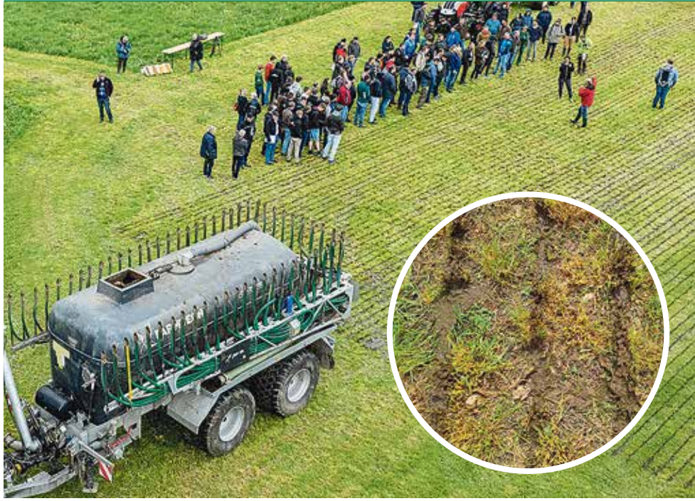
Bodennahe Ausbringtechnik verringert Nährstoffverlust und Futtermittelverschmutzung
